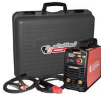
**Generatore con valigia e accessori, ELETTRICITÀ, modello **ECF-2000 INVERTER DC, TIG-MMA**, volt 220/m 50-60 Hz, potenza massima assorbita 4,5 kW , campo di regolazione da 10 ÷ 200 A, DISPLAY DIGITALE, interruttore TIG/MMA, isolamento IP 23 F 25%, potenza massima 200 AMP, 120 AMP al 60%, elettrodi utilizzabili in MMA Ø 1,6 ÷ 5 mm, ARC FORCE, HOT START, ANTI STICK, INNESCO TIG LIFT ARC, dimensioni 300x120x220 h mm, peso 6 kg.**
