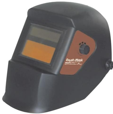
**Schermo oscuramento rapido, modello ENYSH-MASK, CE, campo di regolazione da 9 a 13 DIN, tempo di oscuramento 1/10.000 s, tempo di ritorno al chiaro 0.1-0.5 s, campo visivo 90x110 mm, peso 495 g, alimentazione gruppo ottico a celle solari.**
